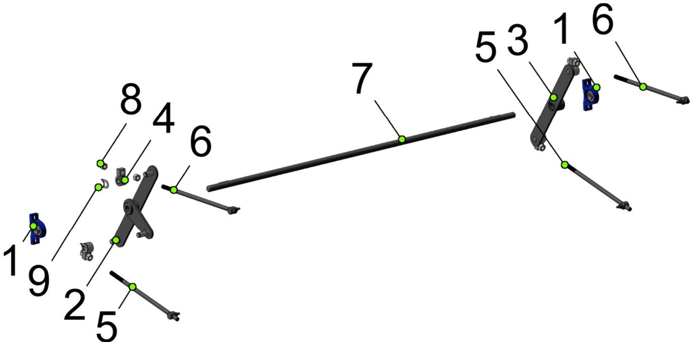
Вал привода щеток ЗВТ 81.070
