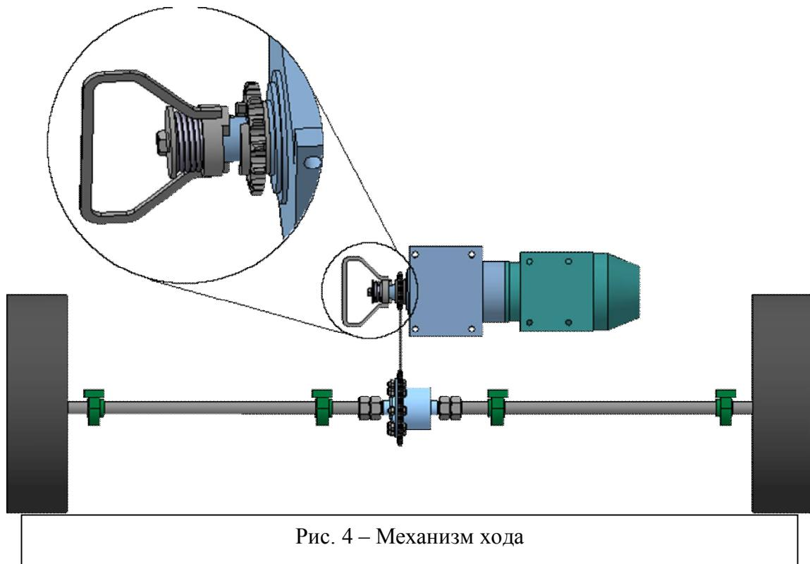
Рис. 4 – Механизм хода
